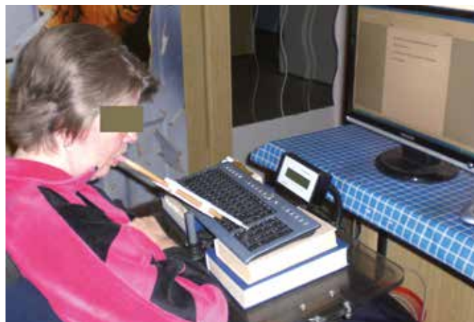
■ Abb. 3: Einfache mechanische Ausführung einer Kopfmaus, mit der Frau U. mithilfe eines Mundstabes eine normale PC-Tastatur bedient (Foto: Wolfgang Ufer)
