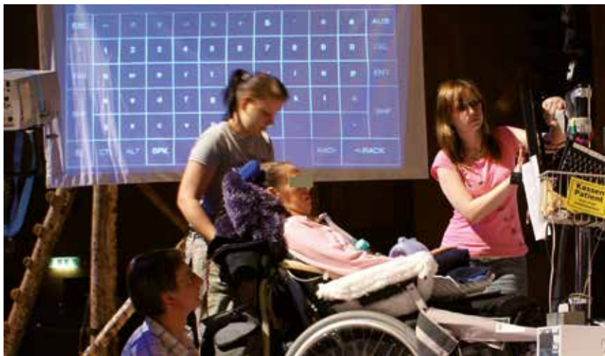
■ Abb. 4: Frau J. mit ihrem Eye-Gaze-System. Vorne an dem Rollstuhl befestigt sind der Computerbildschirm, die Beleuchtungseinheit sowie die Kameraeinheit. Im Hintergrund ist eine Projektion des Bildschirms zu sehen. (Foto: Farah Lenser)
