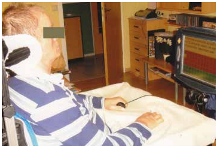
■ Abb. 2: Herr M., dessen Sprach-/Schreibcomputer im Scanning-Modus Zeilen-Spalten arbeitet. Zu sehen ist der Computerbildschirm und der Taster in der linken Hand des Betroffenen. (Foto: Gudrun Müller)
